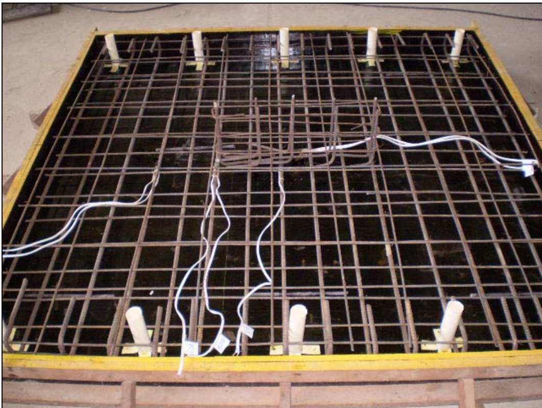
Figura 3.22 – Instalação de extensômetros nas armaduras das lajes com pilares de índice 1 e 7
