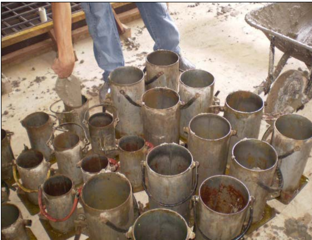
Figura 3.35 – Moldagem dos corpos de prova para os ensaios de resistência do concreto
