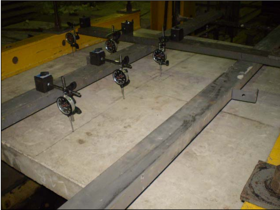
Figura 3.25 - Marcação da projeção do pilar, dos pontos para obtenção dos deslocamentos verticais e colocação da estrutura independente para a fixação dos deflectômetros (laje L1B)
