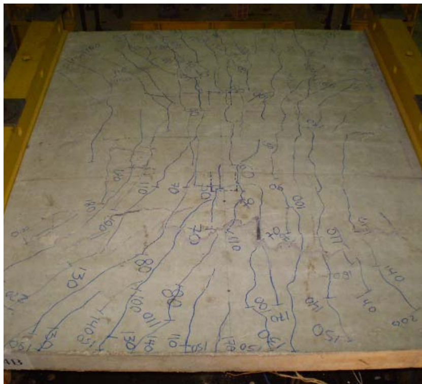
Figura 4.66 – Mapa de fissuração da laje L4B
