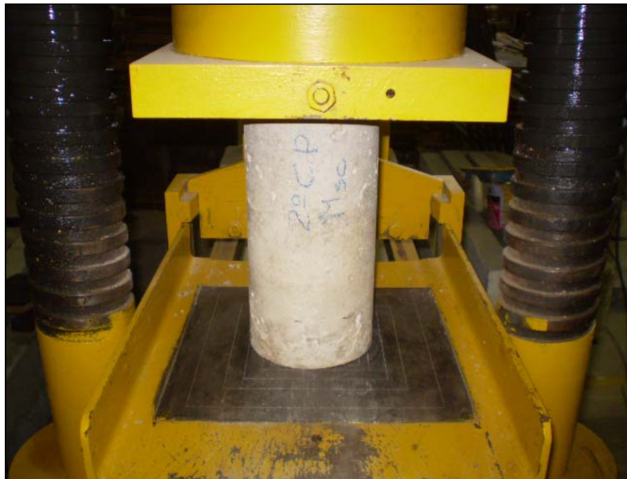
Figura 4.1 – Ensaio típico de um corpo de prova utilizado para determinação da resistência à compressão do concreto
