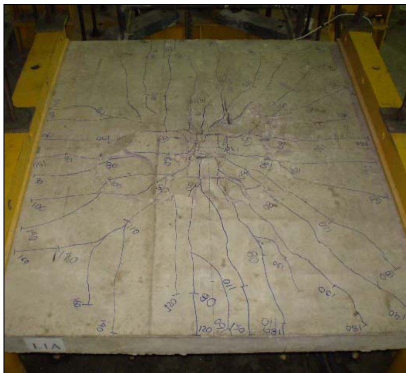
Figura 4.59 – Mapa de fissuração da laje L1A
