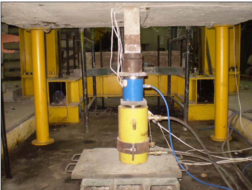
Figura 3.30 – Sistema de aplicação de carregamento típico das lajes
