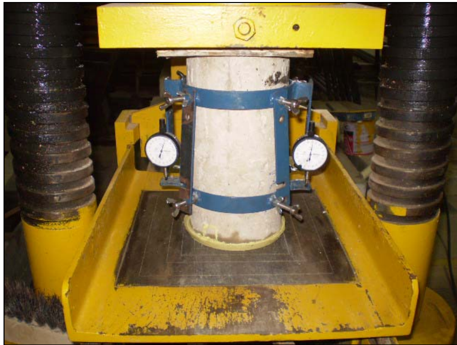
Figura 4.2 – Ensaio para determinação do módulo de elasticidade do concreto
